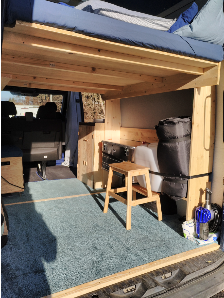
Abbildung 1.9: Bild von Innenraum hinten als alles ausgebaut wurde
