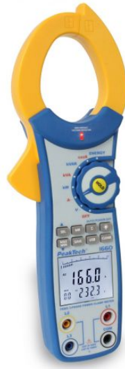
Abbildung 3.2: Amperemeter von PEAKTECH mit USB Anbindung [37]
