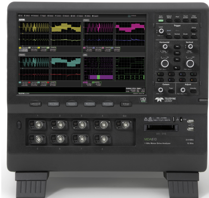
Abbildung 3.1: DSO mit Digital Analyzer von LECROY [32]
